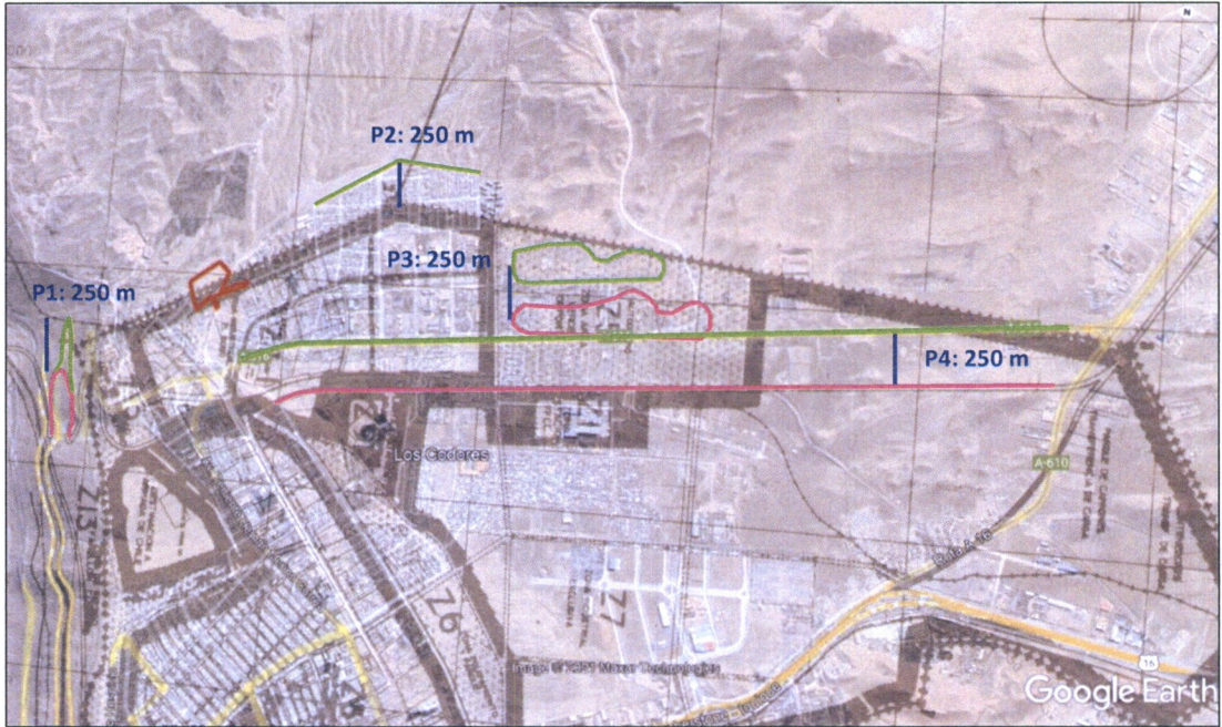
Imagen N°7: Puntos de verificación de desfase de 250,00 m entre el Limite Urbano Norte del plan Seccional y el límite Norte real del Sector El Boro.
