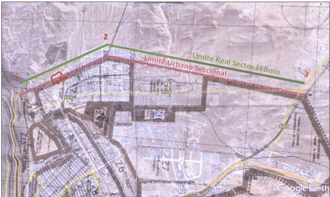
Imagen N°8: Puntos de verificación de desfase de 250,00 m entre la Representación Planimétrica del Limite Urbano del Plan Seccional (línea segmentada color magenta) y el Límite Urbano real del área normada por el Plan Seccional en el Sector El Boro (línea continua color verde).
